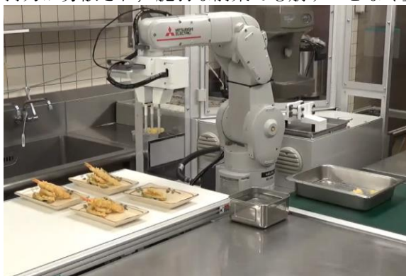
Fig. 15 3本棒ハンドの実験様子
