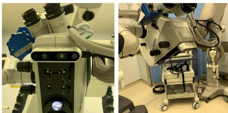
図4 D435 をマイクロスコープに装着した様子.
