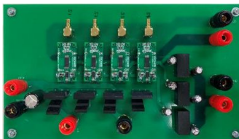
Fig. 3 SiC を H-ブリッジに用いた PWM インバータドライブ部基板写真とプリント パターン
