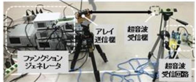
図7 構築したフェーズドアレイ送信機
