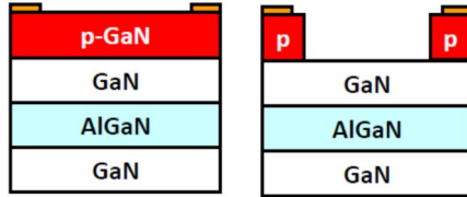
図2-1 (左) 試料P、(右) 試料H。いずれも AlGaIn 層の下側に2DEGが、上側に2DHGが存在する。上部層のエッチングにより2DHG濃度を変えている。室温での電気特性は P/H: シートホール濃度 n_s \sim 1.3 / 0.32 \times 10^{13} / \text{cm}^2 、移動度 \mu_n \sim 12 / 7 \text{ cm}^2/\text{Vsec} 。
