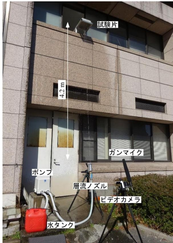
図-7 水滴の衝突を利用した高所検査
