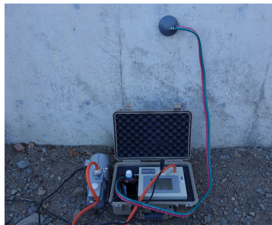
図-1 表層透気試験（トレント法）
