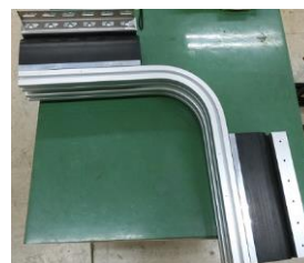
写真5 バルジング用制振装置
