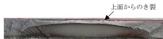
(b) 曝露した破断面の例
