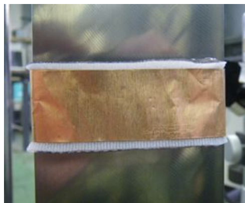
図4 平板試験片に適用した進展抑制シート(流電陰極層あり)
