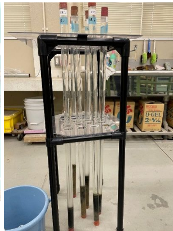
左図：採泥器で採取した底質 中図：室内実験向けに採取した乱れない底質コアサンプラー 右図：耕耘実験中における濁度の鉛直プロファイル
