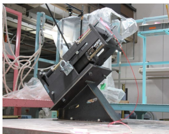
図 1 TMD 単体の振動台実験の様子
