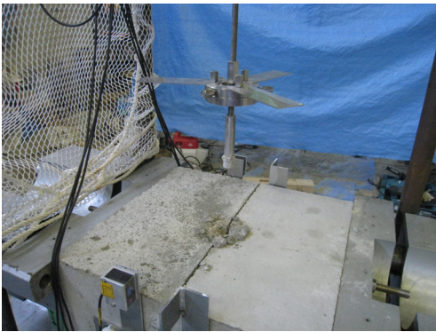
写真2 載荷後のアンカーの様子 (M16 試験体)
