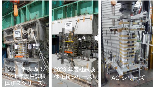
写真2 能動横拘束後の水平加力及び圧縮実験
