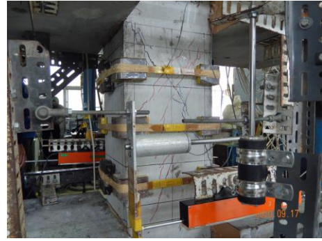
写真1 せん断損傷実験
