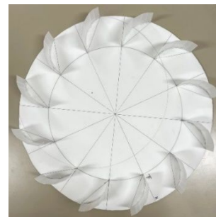
図 5 クロスフロー風車（円弧翼）概要
