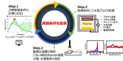
図2：本研究にて実施した HPT のベイズ最適化プロセスの概略図
