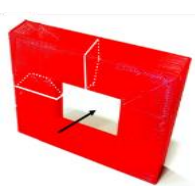
図3 特殊加熱コイル (コイル傾斜角 \alpha = 45^\circ )
