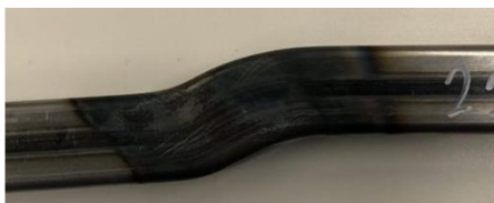
(a) せん断角 \theta=45^\circ 出側速度 V_x=2\text{mm/s} , V_y=2\text{mm/s}
