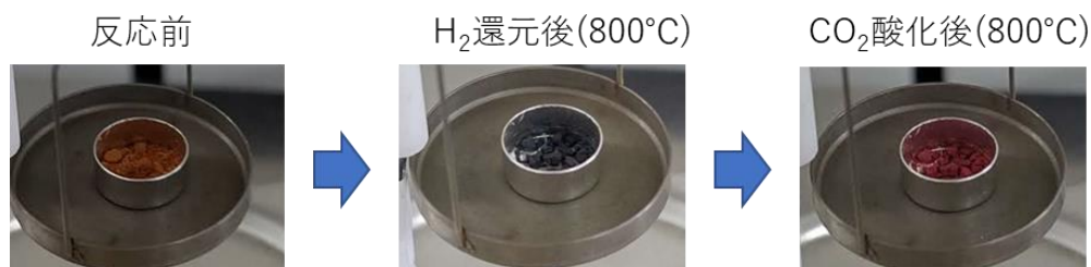
図2 Fe:Ce=1:1 の \text{FeO}_x\text{-CeO}_2 球状多孔体の TGA 分析中の外観変化
