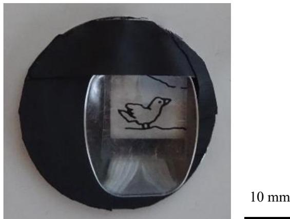
図 10 透明スプーンを利用して作成した凹面レチクル
