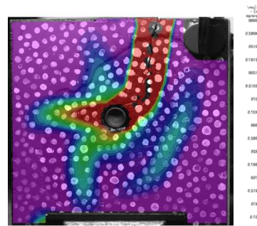
図5 DICで計測した石炭表面の主ひずみの分布の例
