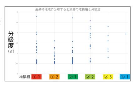
Distributary Channel ~ Proximal Lobeに堆積する高密度堆積物重力流, 男鹿半島北岸の北浦層はDistal LobeやLower Fanに堆積する低密度堆積物重力流, 脇本層は外側陸棚の堆積物であると考えられる.砂の淘汰度の良さと砂岩貯留岩性状には密接な関連があり(西澤ほか, 2009), 不淘汰な砂は貯留岩性状下げる要因であると考えられる.本研究における粒度分析結果を基にした分級度より,重力流堆積物では生鼻崎地域に分布する北浦層の塊状砂岩部が,最も良好な貯留岩性状であった.さらにこれらの塊状砂岩単層内には主に, 赤褐色・赤褐色を除く褐色系・灰色系の3つに分けられ, これらの色と貯留岩性状に関連があることが明らかになった(図1).
