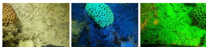
図 7 登野城漁港（沖縄県石垣市）における多波長励起式蛍光撮影装置を搭載した小型 ROV による蛍光撮影試験
