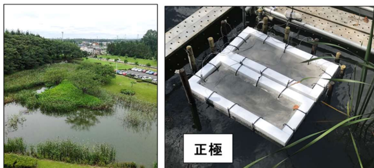
図2 農研機構畜産部門つくばの敷地内の池(左)と設置したMFCの正極(右)
