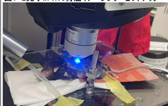
図1 2光子 in vivo 胃癌イメージング セットアップ
