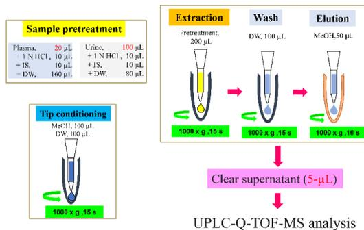
図1. モノリス型SPEスピントップ試料前処理手順
