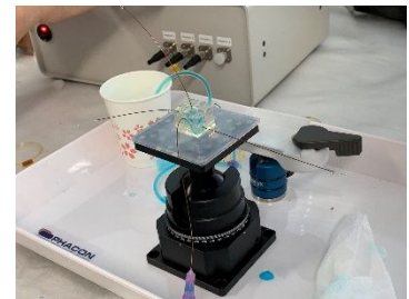
図3 ~ は灌流または圧力測定のために設けた細管( 直径 0.35mm )
