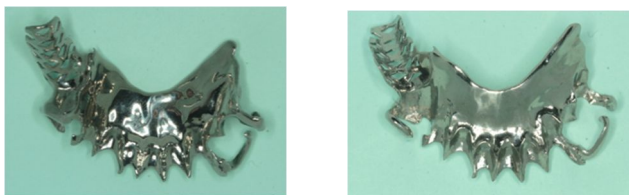
図3 積層造形により製作したチタン合金フレームワーク
