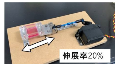
図 2. 細胞に機械的ストレスを加える伸展装置
