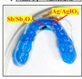
今回試作したマウスピース型センサデバイスを左図に示す。 安静時の連続 pH 測定では、十分な時間分解能と検出力(感度) を有することが確認することができた。ストレス負荷時の唾液 pH も実測することができ、データの変動を捉えることも可能であっ た。さらに運動シーンでの実測を見据えて、デバイスの一部無線化
