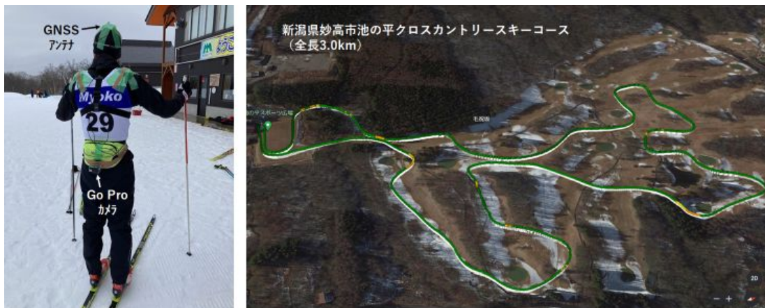
図 3．実験方法 被験者（ワールドカップ出場経験者）の頭部に高精度ウェアラブル GNSS，腰部にビデオカメラを装着．全長 3km のクロスカンリースキーコースでタイムトライアルを実施．
