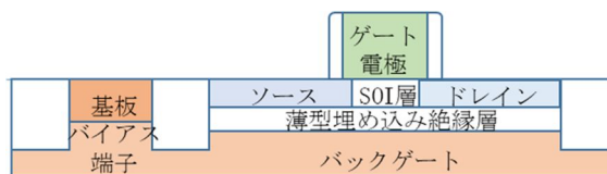
図2 薄型BOX-SOIトランジスタの断面構造
