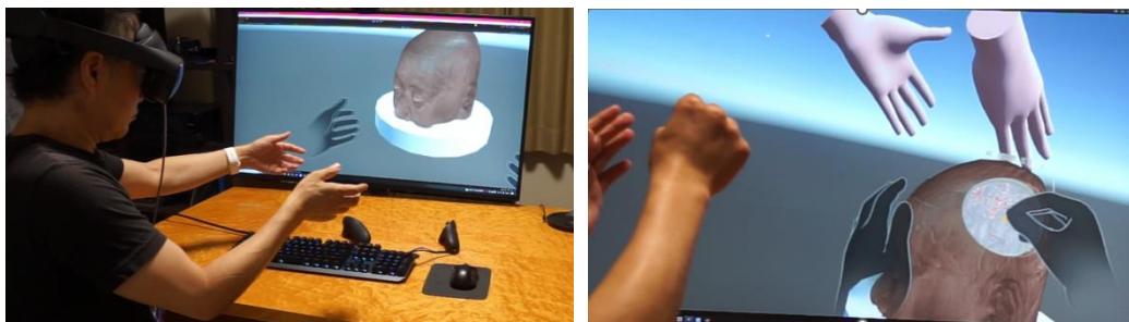
図7 HMDで頭蓋骨を3D体感（左）と頭蓋骨に穴をあけてCTやMRIで撮像したDICOMペアで表現された脳内部を閲覧（右）.
