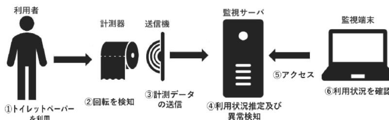
図3. トイレトーパーの利用状況監視システム
