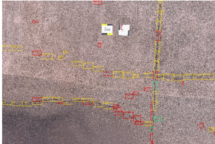
図 2 飛行高度 10m の画像を検知プログラムにより検知した結果
