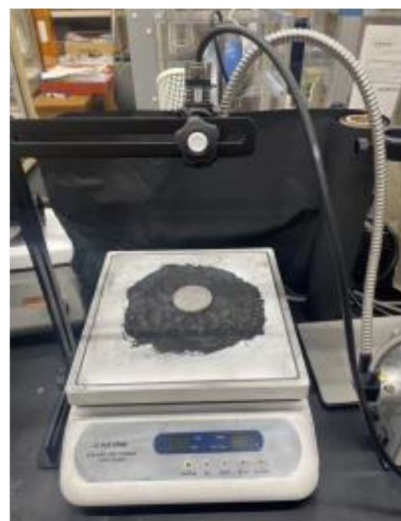
図8 バルク体試料の時分割加熱挙動の観察・スペクトル測定システム
