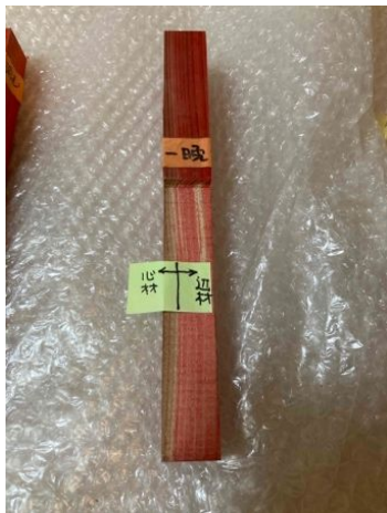
図 6 心材と辺材の染色
