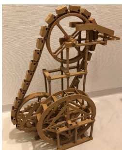
図3(左). すでに消失した歴史的造形資源「藤原式揚水機」のデジタル復元
