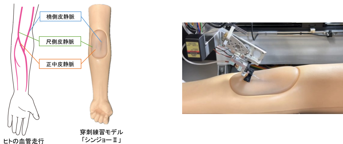
Fig.3 採血練習モデル（左）と採血ロボットによる自動穿刺の結果の例（右）
