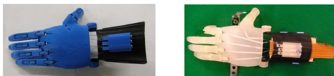
図1 試験サンプル(左:FDM方式、右:光造形方式)
