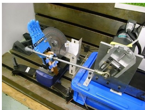
図 5 3D 積層造形義肢装具の試験評価システム
