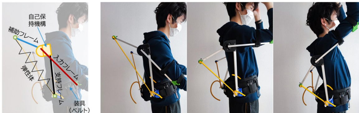
図 2 双方向クラッチ機構による受動型アシストスーツモデル
