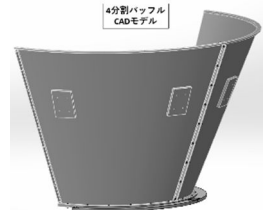
図 4: 四分割バッフルの完成品と CAD モデル。補助リングを用いて精度を維持し組み立てる。
