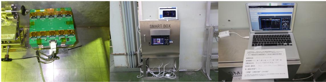
図 2 ガンマ線照射試験の様子。QST 高崎研のコバルト 60 照射施設ではスマートボックスと eduroam を利用することで照射中の機器の状態を遠隔からモニターしながら試験できる。
