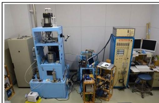
図 1: 掘削実験に用いた高速せん断試験機 実際の掘削環境を模した掘削実験に使用する回転式試験機。(海洋研究開発機構に設置)
