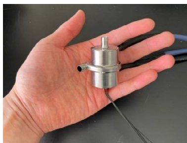
図5 製作した小児用人工心臓第二試作機
