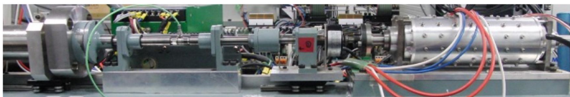
図3 スパイラルモータ試作2号機 波力模擬実験
