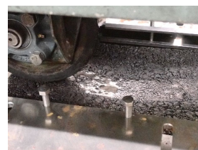
写真-3 試験中における土砂噴出
