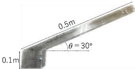
図 5 水位の影響評価に利用した実験模型
