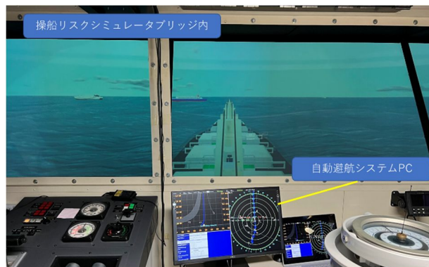
図2 操船リスクシミュレータと自動避航システム
