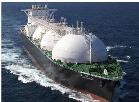
図 1 独立球形タンク方式の LNG 運搬船<sup>5)</sup>
