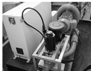
図2 実変動風圧载荷装置 (東北大学所有)
